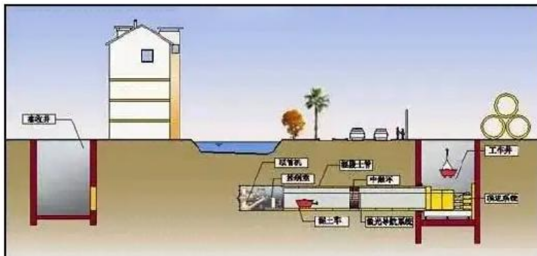
图 3.2-3 顶管施工示意图
